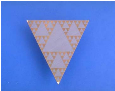
Figura 4 Antena Fractal Multibanda
